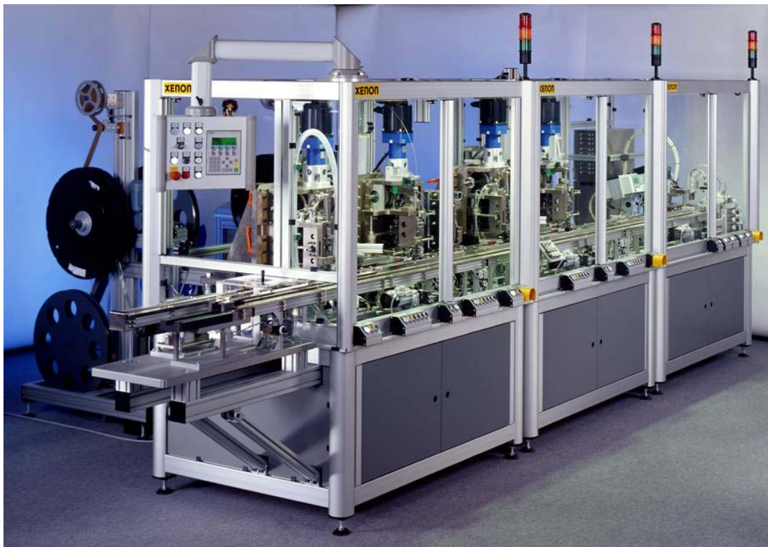
Bild 1: Automat zur Montage von Kontaktbaugruppen
